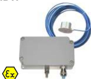
Інклюнометр використовує ємнісний метод вимірювання для вимірювання нахилу (вимірювання кута) на жалюзях дамби.
